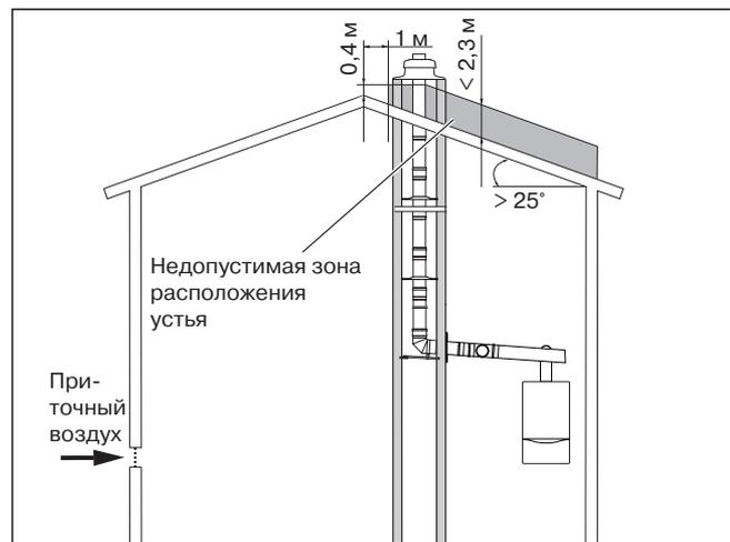
**Рис. 2.2 Недопустимая зона расположения устья при наклоне крыши > 25°, но только в том случае, если отверстия для притока воздуха и шахта расположены на противоположных сторонах конька крыши**
