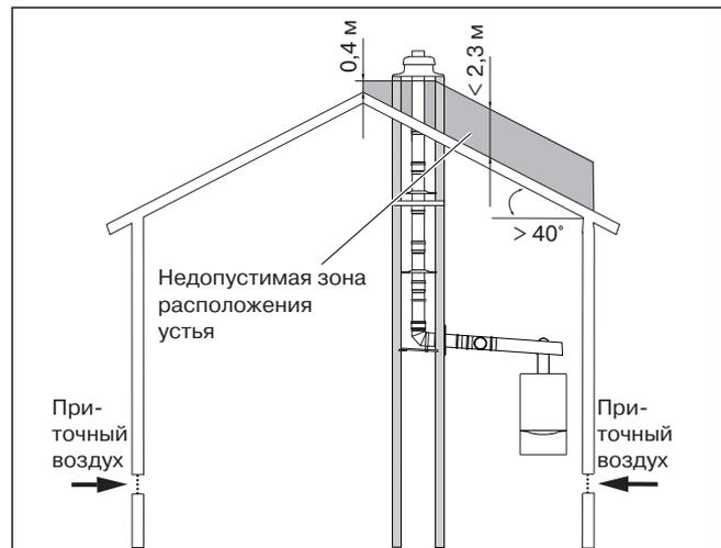
**Рис. 2.1 Недопустимая зона расположения устья при наклоне крыши > 40°; независимо от положения отверстий для притока воздуха**
